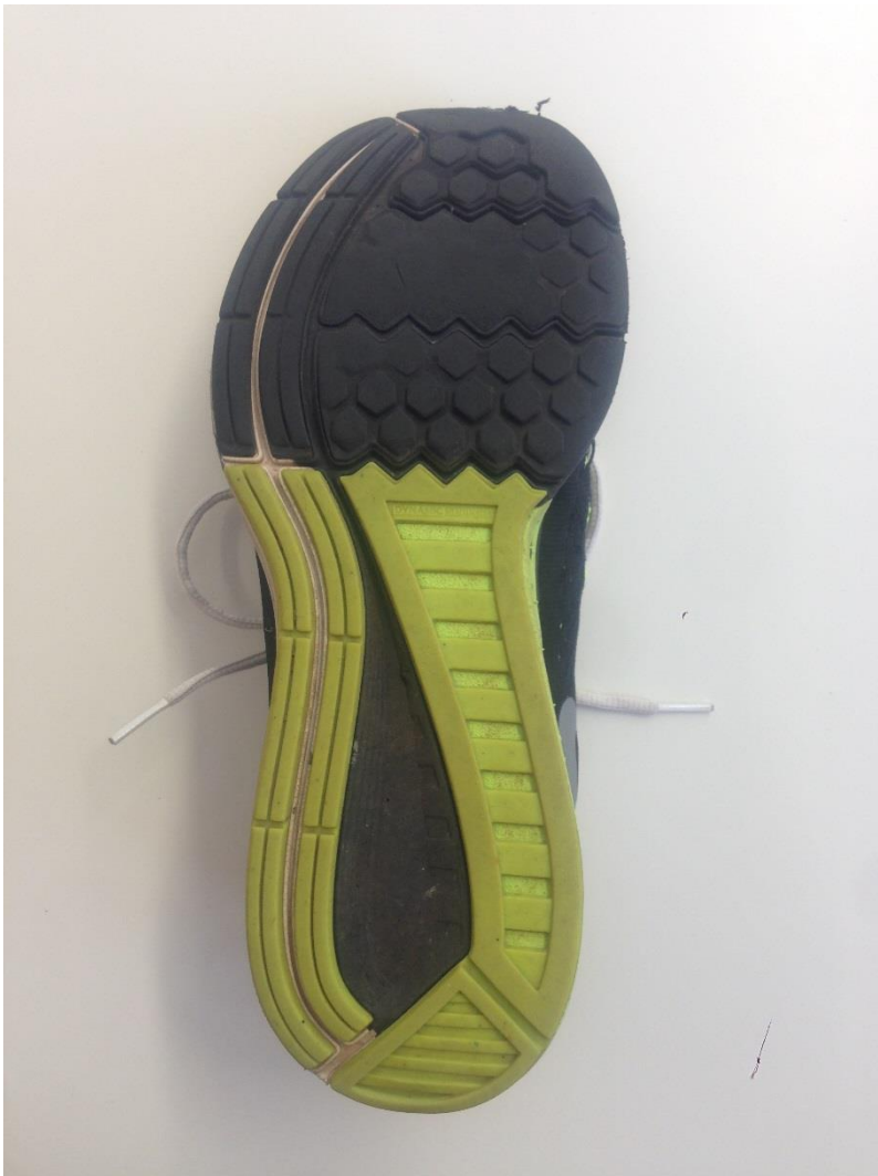
Abbildung 2 Typisches Abriebmuster einer Schuhsohle, wo zu viel Druck in der Mitte des Vorfusses vorhanden ist.
